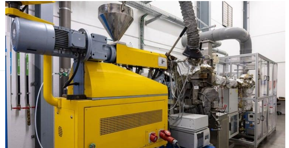
Réacteur pilote en continu Continue pilootreactor Capacité de 20 L – Capaciteit van 20 L kg/h – kg/u
