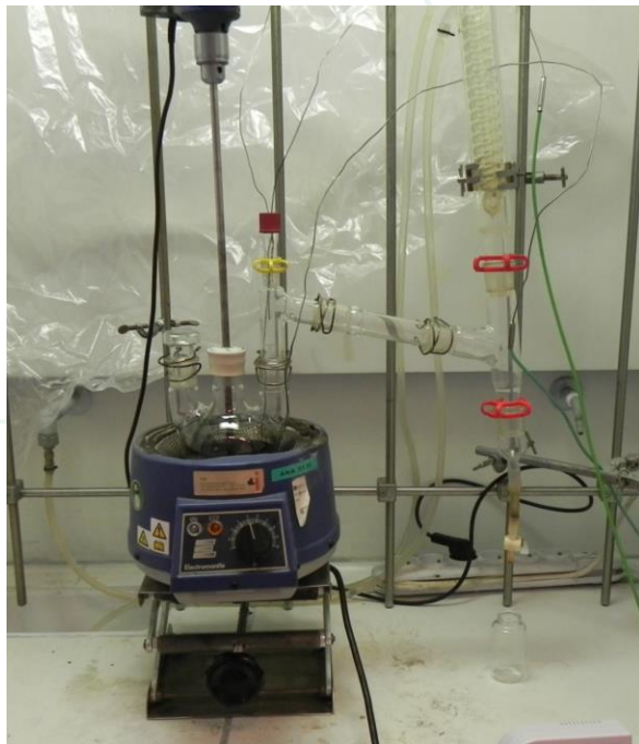
Réacteur batch en laboratoire Batchreactor in het laboratorium Capacité de 500 mL Capaciteit van 500 mL
