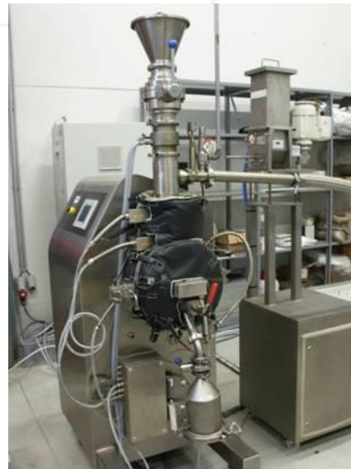
Réacteur pilote batch Batch pilootreactor Capacité de 20 L Capaciteit van 20 L
